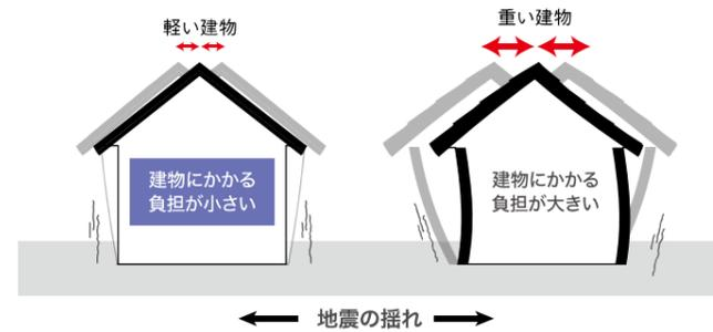
地震による建物への負荷は、建物の重さに比例して増大するため、建物の重さが重いと地震時の建物の揺れ幅も大きくなります。軽量なアイジーサイディングを使用した場合、建物の重さも軽くなるため、地震時の揺れ幅も小さくなります。また、建物の柱や梁などの躯体にかかる負担も低減できます。
