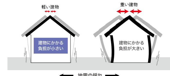
地震による建物への負荷は、建物の重さに比例して増大するため、建物の重さが重いと地震時の建物の揺れ幅も大きくなります。軽量なアイジーサイディングを使用した場合、建物の重さも軽くなるため、地震時の揺れ幅も小さくなります。また、建物の柱や梁などの躯体にかかる負担も低減できます。
